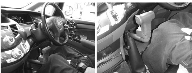
図1：運転補助装置の事例
